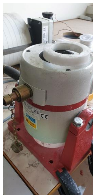
Сурет 2.7 – LDS V650 модельді электродинамикалық шейкер
